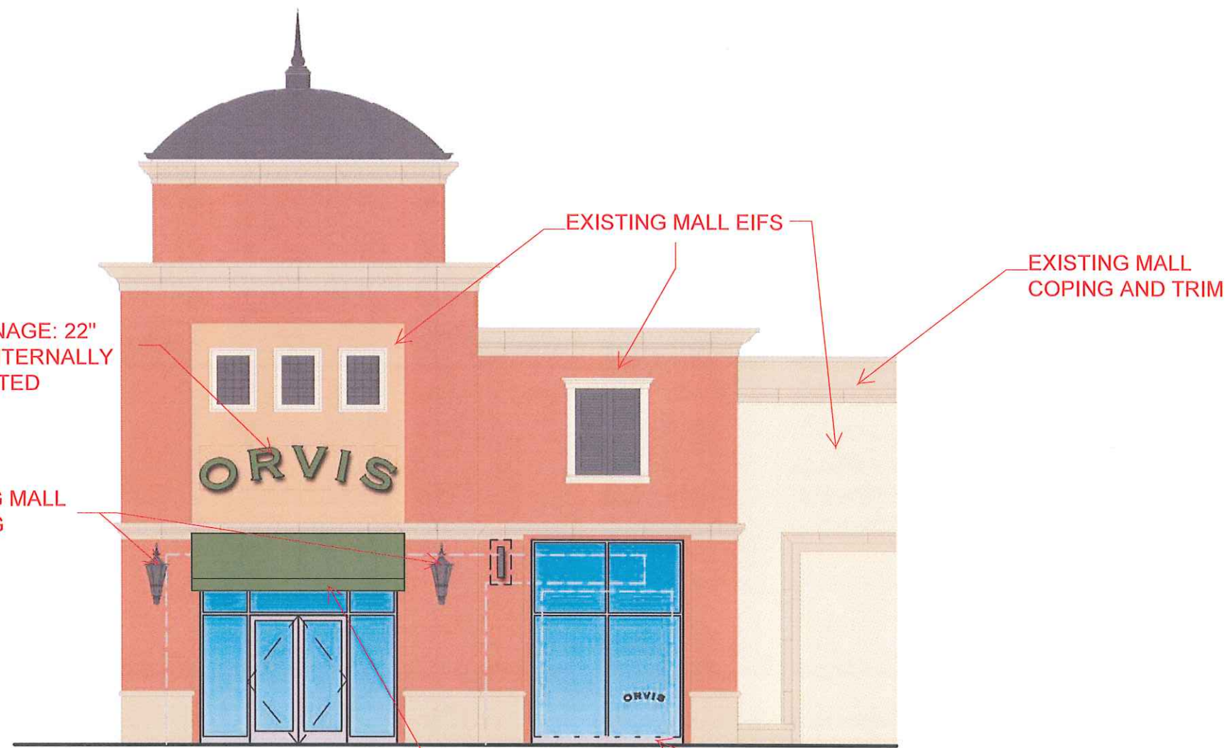
3 STOREFRONT WEST ELEVATION SCALE: 1/8" = 1'-0"
